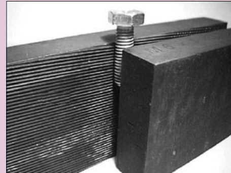
5. Roulage d'une vis à tête hexagonale par peignes rectiligne
