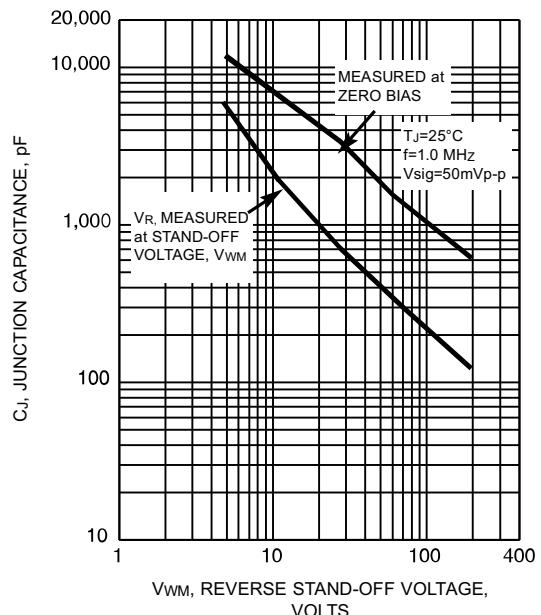
**FIG. 5 - TYPICAL JUNCTION CAPACITANCE BI-DIRECTIONAL**
