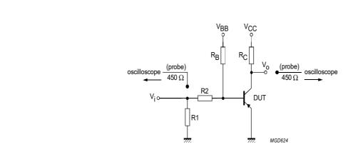
$$\begin{split} &V_i = -9.5 \; V; \; T = 500 \; \mu s; \; t_p = 10 \; \mu s; \; t_r = t_f \leq 3 \; ns. \\ &R1 = 68 \; \Omega; \; R2 = 325 \; \Omega; \; R_B = 325 \; \Omega; \; R_C = 160 \; \Omega. \\ &V_{BB} = 3.5 \; V; \; V_{CC} = -29.5 \; V. \end{split}$$
