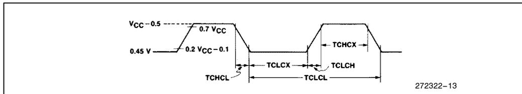
**AC TESTING INPUT, OUTPUT WAVEFORMS**
