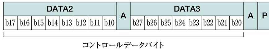
アドレスバイトの内、先頭の7ビットはスレーブアドレスに、残りの1ビットがR/Wビットに割り付けられます。コントロールレジスタとして使用する場合は、R/Wを0に設定します。MM1763のスレーブアドレスは90Hとなります。
