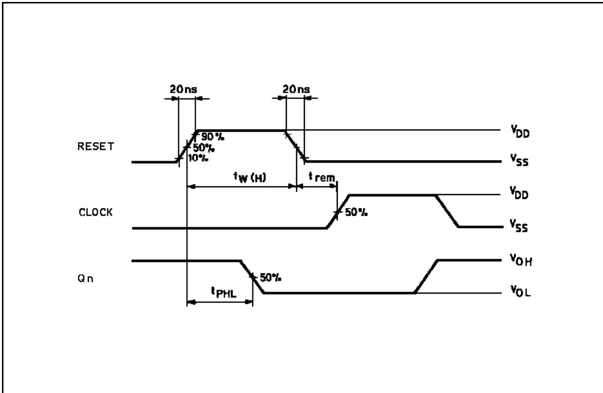
WAVEFORM 2 : PROPAGATION DELAY TIME, MINIMUM PULSE WIDTH (f=1MHz; 50% duty cycle)
