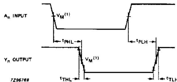
(1) HC :  $V_M = 50\%$ ;  $V_I = \text{GND to } V_{CC}$ .
