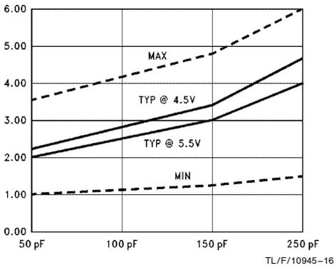
**$t_{PHL}$  vs Load Capacitance**
