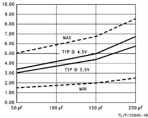
**$t_{PHL}$  vs Load Capacitance**
