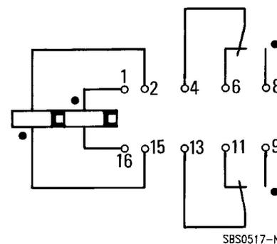
Ruhestellung entspricht gezeichnete Schaltstellung. Liegt an Anschluß 1 oder 15 Plus-Potential, nimmt das Relais die Arbeitsstellung ein.
