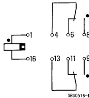
Ruhestellung entspricht gezeichnete Schaltstellung. Liegt an Anschluß 1 Plus-Potential, nimmt das Relais die Arbeitsstellung ein.
